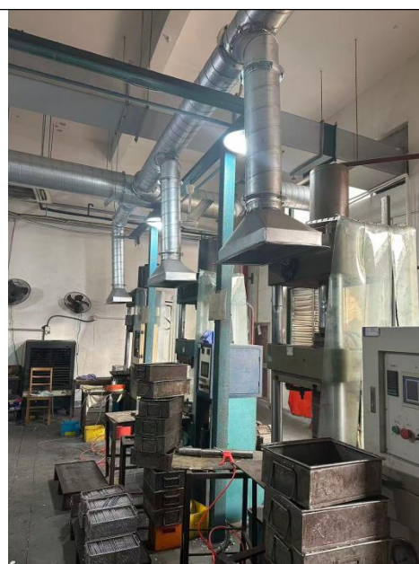
热固性塑料液压成型机操作口上方设置集气罩, 周围设置软帘
