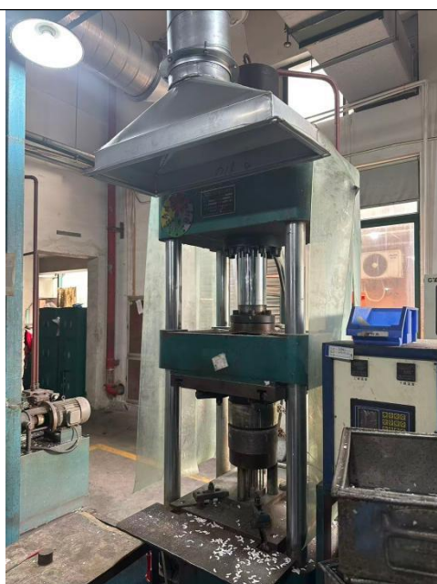
热固性塑料液压成型机操作口上方设置集气罩, 周围设置软帘
